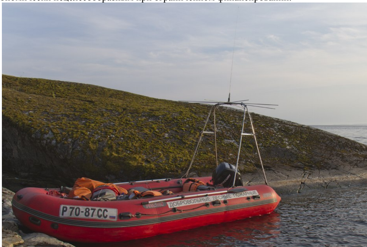
Лодка ОДЛП с установленной на тарге с ходовыми огнями площадкой противовесов и автомобильной антенной для связи на частоте 27 МГц.
