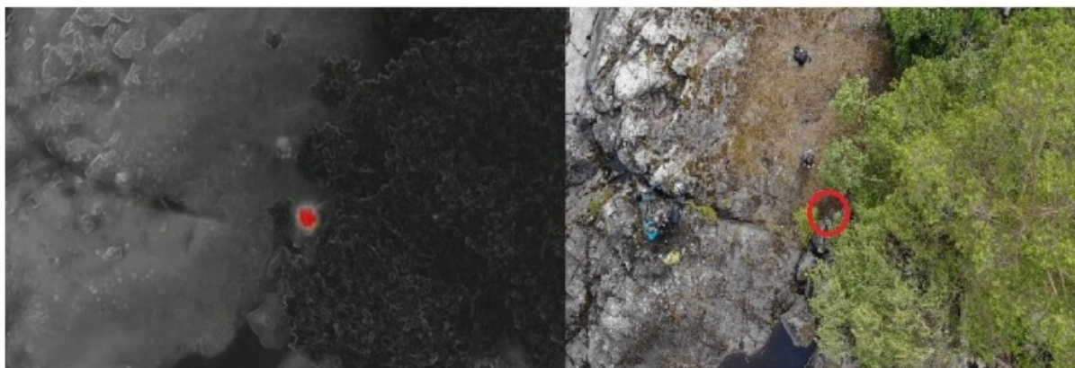
Фотографии погасшего костра (в тепловизионном и визуальных режимах), сделанные коптером Mavic 2 Enterprise Dual с высоты около 40 метров. На тепловизионной фотографии место костра отчетливо видно, тогда как при обычном осмотре с земли такой костер не будет вызывать опасений, поскольку огня и дыма давно нет.
